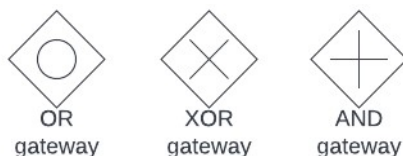
Slika54 Zapisi vrat OR, XOR in AND
